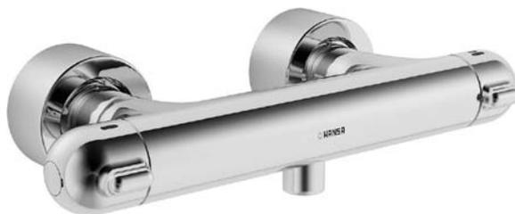
Der Thermostat „Hansacare“ wurde für den Pflegebereich konzipiert: Eine Heißwassersperre, die auf 38 °C voreingestellt ist, schützt vor Verbrühungen und kann individuell für höhere oder niedrigere Maximaltemperaturen nachjustiert werden. Zudem sind die Anschlüsse verdeckt und dreifach abgedichtet – so können sich keine Keime hinter den Abdeckungen festsetzen.
